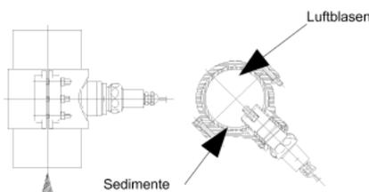
Die beste Einbaulage (geringere Verschmutzung, gute Entlüftung) ist mit Durchflussrichtung von unten nach oben oder bei waage- rechter Rohrführung mit  $45^\circ$  nach unten zeigendem Sensor gege- ben. Die Überwurfmutter muss mit 30 Nm angezogen werden.
